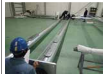
工場検査 (照明柱)
